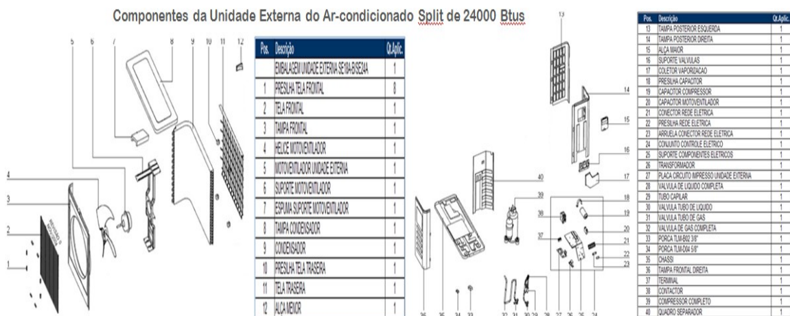
Figura 9: Unidade externa do ar-condicionado split
