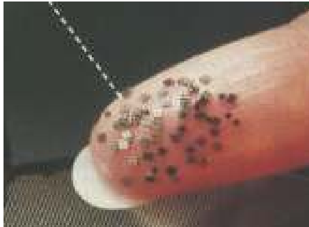
Figura 16: Componente SMD – Referência de Tamanho Físico.
