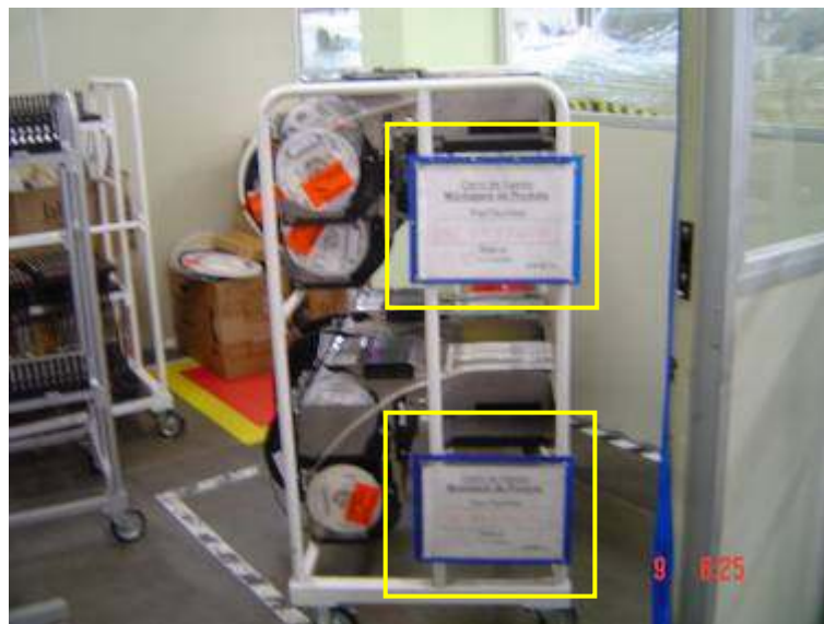
Figura 43 – Melhoria da identificação do Feeders (Situação Depois 2). Fonte: Autor
