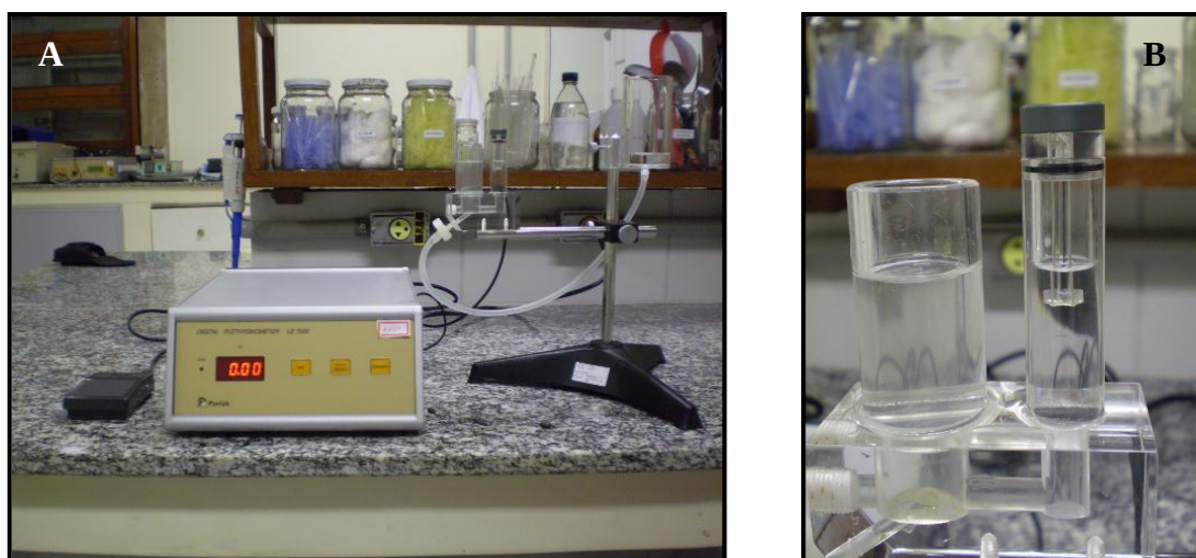
Figura 4.8 – Plestimômetro utilizado na análise de atividade antiedematogênica. A – equipamento completo; B – detalhe do eletrodo de leitura.
