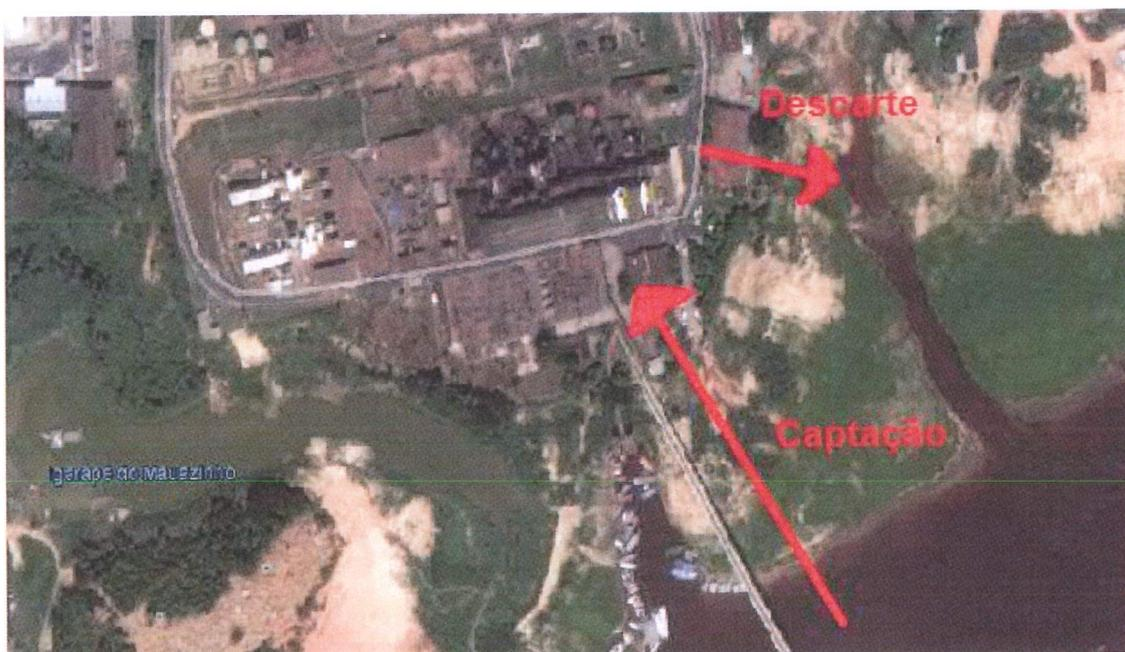
**Figura 32:** sentido da captação de água para resfriamento de turbinas, e seu descarte no rio Negro. Autor: Frederico Cesarino, a partir de imagem de satélite.
