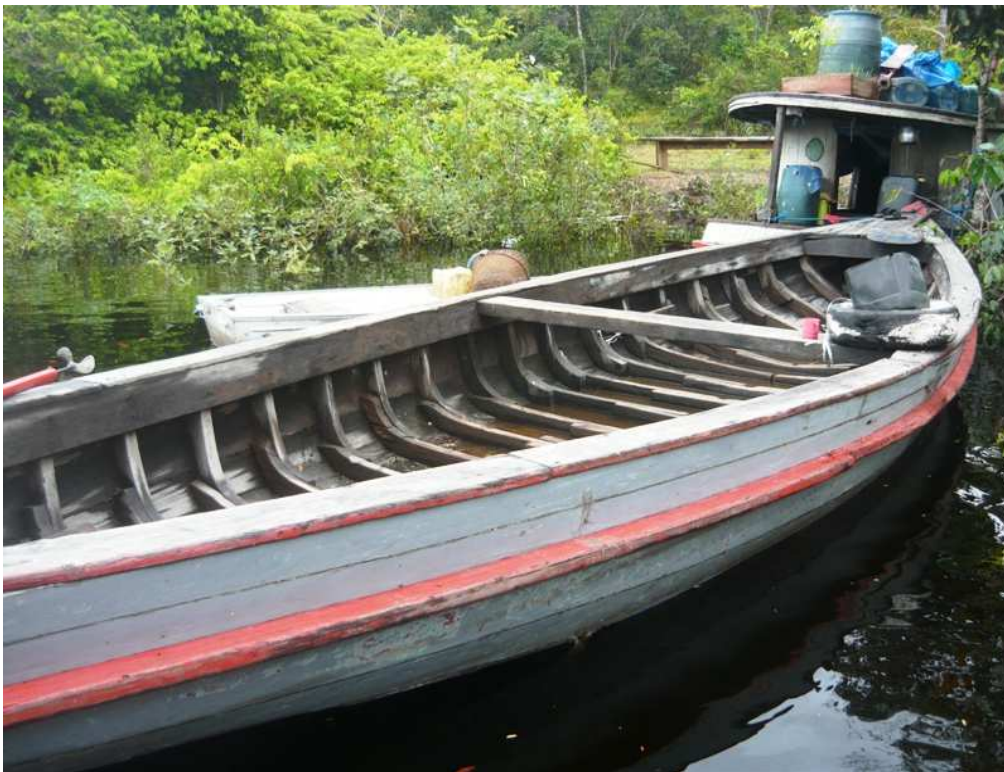
Embarcação conhecida como “chata” utilizada para transportar a piaçaba da colocação à paragem, onde esta será pesada.
