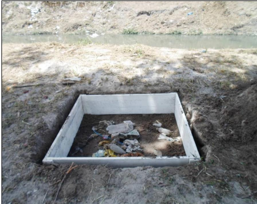
Figura 9: Demonstração do uso do gabarito nas coletas de amostra de solo
