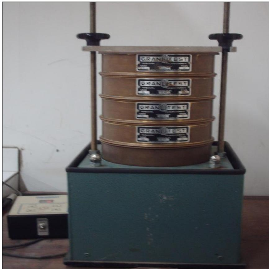
Figura 13: Ensaios com amostras de solo para definição das classes granulométricas.
