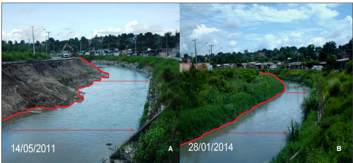
Figura 34: Dinâmica da formação das barras sedimentares tecnógenas em canais retificados. (A) processo de remoção de barra sedimentar; (B) Expansão da barra sedimentar no leito do canal. Fonte: Atividade de campo em maio de 2011 e janeiro 2014.
