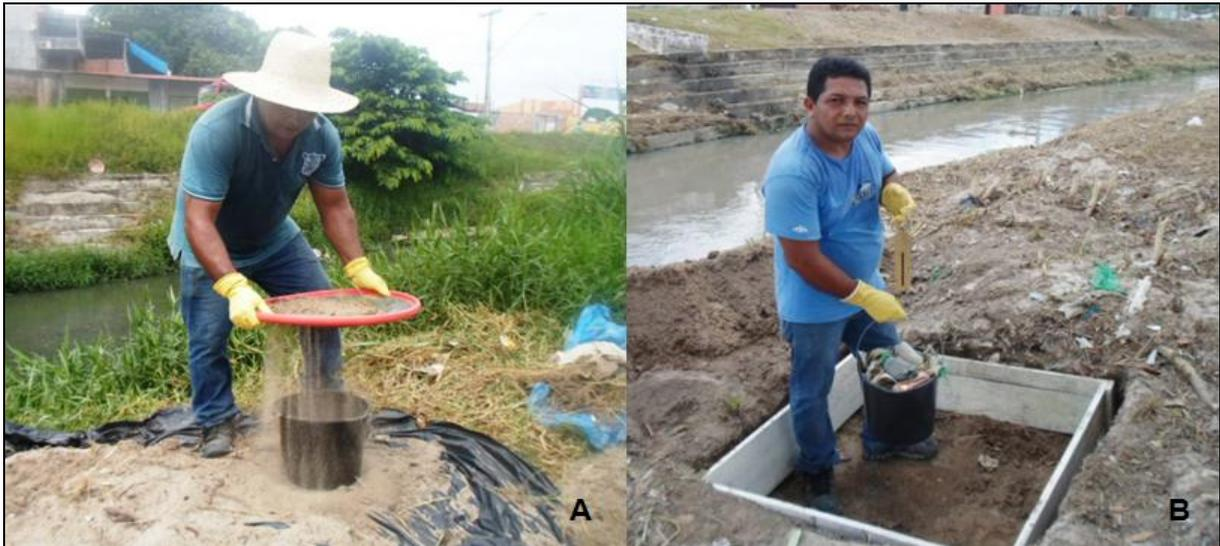
Figura 10: Coleta de solo na microbacia do Passarinho: (A e B) Segregação e pesagem de solo e lixo
