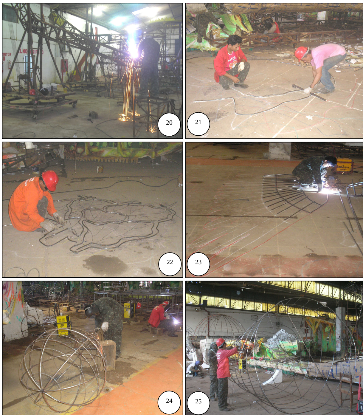
Figuras 20-25: Soldagem de estruturas de sustentação (20), projeção em escala para molduras em aço (21), modelagem em aço (22), montagem e soldagem de moldes em aço para esculturas em ferro (23-25) nos galpões do Garantido.
