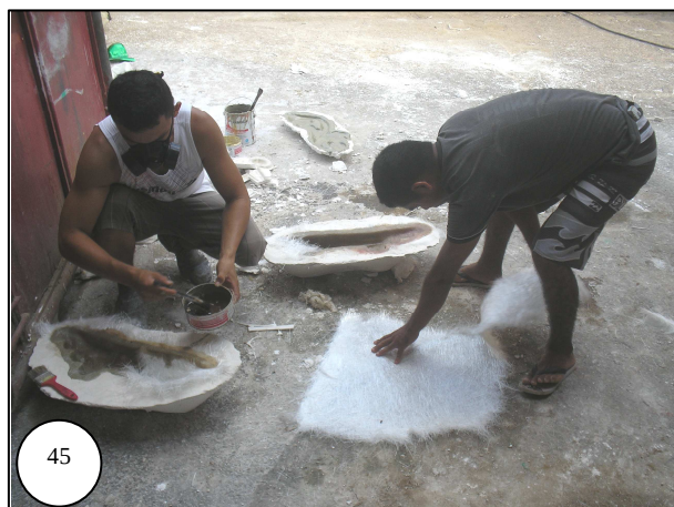
Figuras 42-45: Montagem e soldagem de estruturas metálicas de tuxauas (42), revestimento de estruturas de indumentárias de tribos (43) e produção de adereços em E.V.A na máquina “Vacque Forme” (44) e em fibra de vidro (45) no Galpão Tribal do Garantido.
