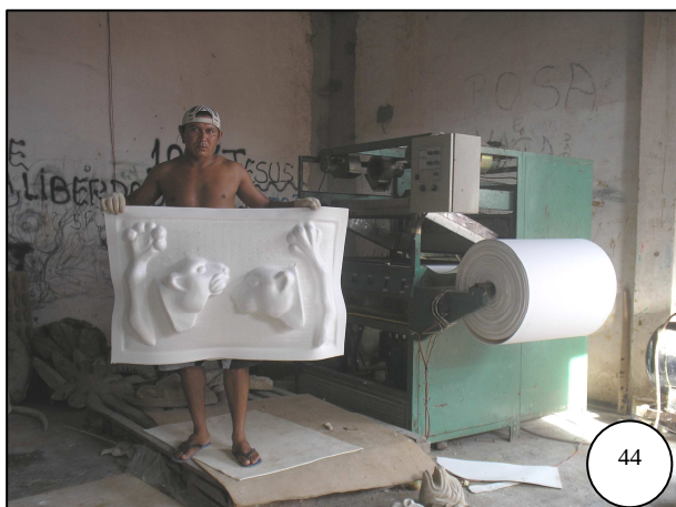
Figuras 42-45: Montagem e soldagem de estruturas metálicas de tuxauas (42), revestimento de estruturas de indumentárias de tribos (43) e produção de adereços em E.V.A na máquina “Vacque Forme” (44) e em fibra de vidro (45) no Galpão Tribal do Garantido.
