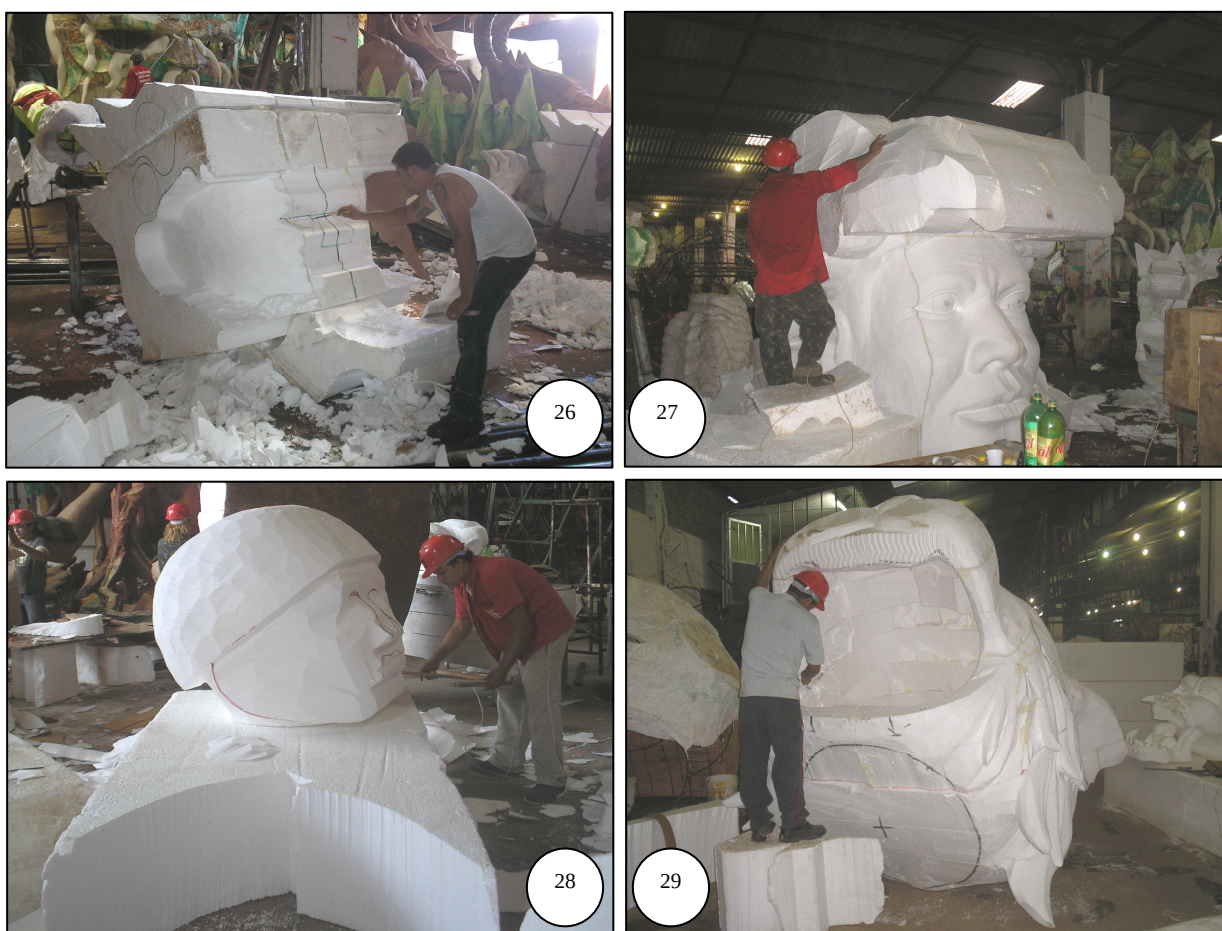
Figuras 26-29: projeção em escala (26) e confecção de esculturas em isopor com técnica de “resistência de chuveiro” (27 e 28), e acabamento da peça com facas (29) nos galpões do Garantido. Fotos: Waldemir R. Costa Jr. Maio, 2011.
