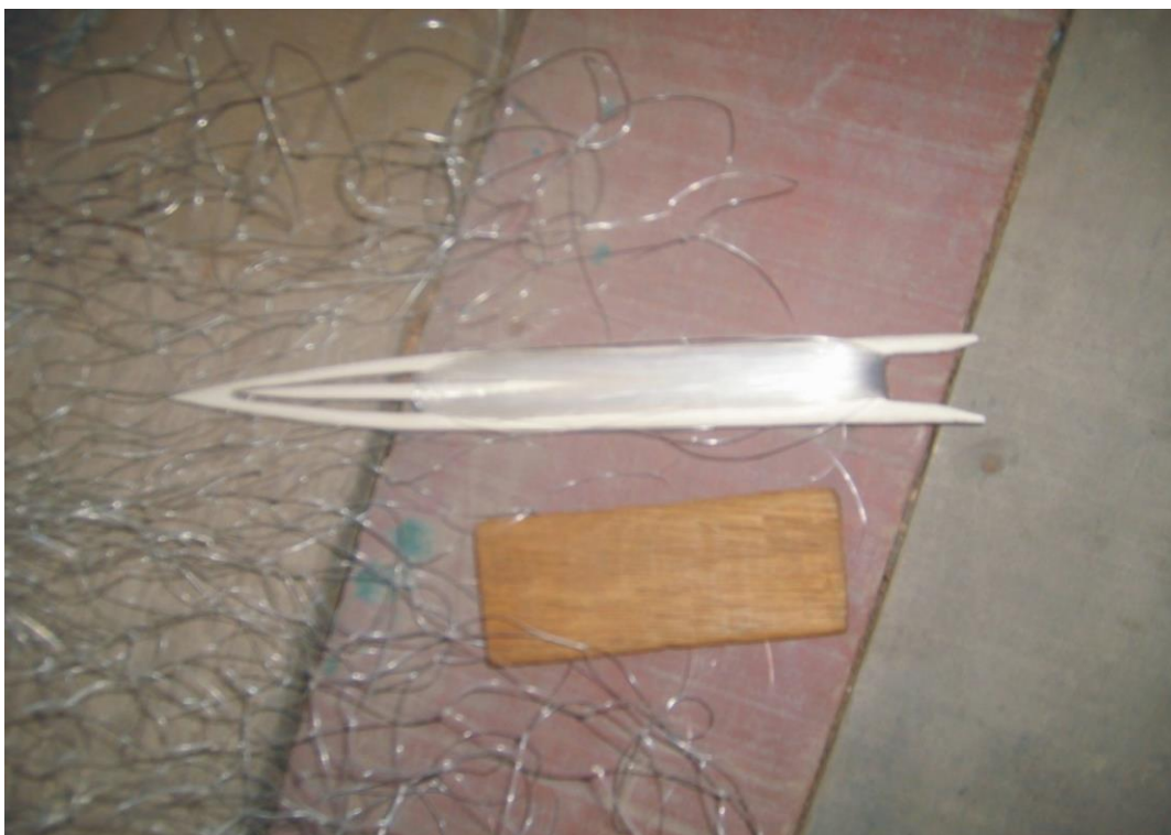
Fig. 11 – Pinto, Iléia Maria de Jesus. Agulha, linha e régua instrumentos utilizados na produção de malhadeiras. Manaus-Am (2007).
