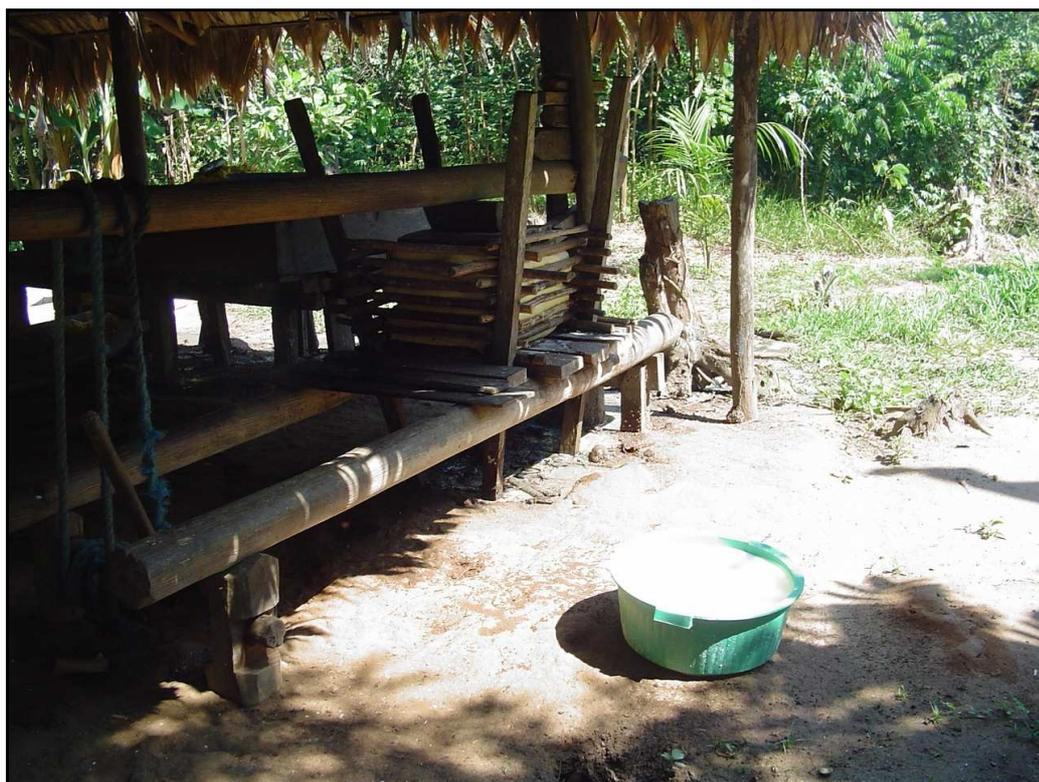
Figura 39 - Prensa de madeira utilizada para "espremer a massa". Na bacia, a massa hidratada, em decantação, para a retirada da goma.
