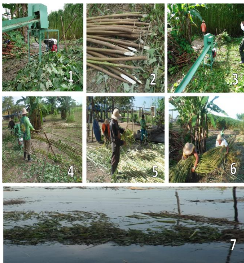
Figura 43: Esquema para obtenção de fibra mecanizada (1-Montagem, 2-Corte e formação dos feixes, 3-Acomodação dos feixes, 4-Corte para separação das fibras, 5-Separação da fibra do caule, 6-Transporte para o rio, 7-Afogamento das fibras).
