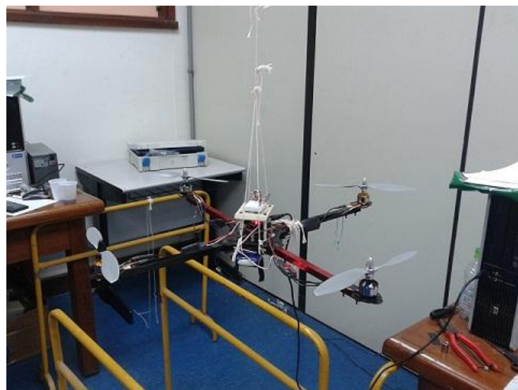
Figura 5.2. Estrutura de teste para o ângulo de guinada ( yaw ).
