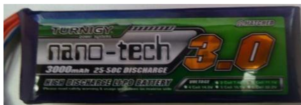
Figura 3.8. Bateria Turnigy modelo nano-tech 3S (11,1Volts) 3000mAh 25-50C.
