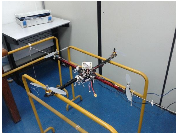
Figura 5.1. Estrutura de teste para os ângulos de arfagem e rolagem ( pitch e roll ).
