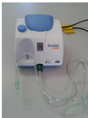
Figura 6- Compressor de ar comprimido portátil (Inalar compact – NS, Brasil)
