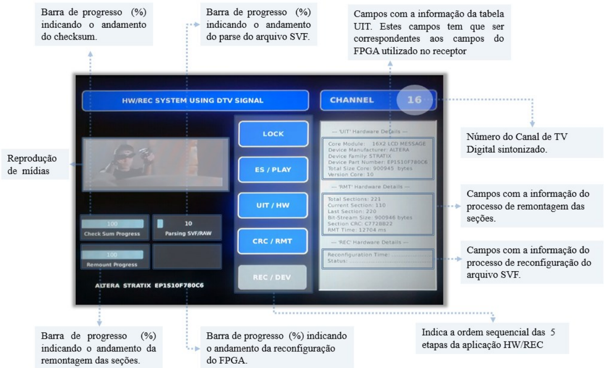
Figura 31 – Interface gráfica (GUI) da aplicação residente HW/REC
