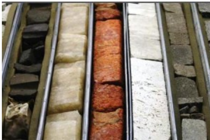
Figura 2.11. Amostras de testemunho retirados de um poço. Apesar de ser a melhor representação do perfil de um poço, é um processo longo e caro, sendo feito portanto somente em alguns poços estratégicos.
