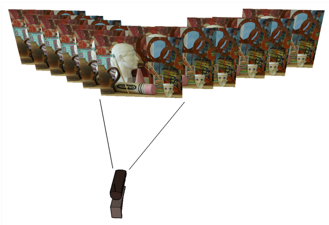
Figura 3.3: Processo de captura de imagens com variação de foco. A partir de mudanças na distância focal da câmera é possível obter um conjunto de imagens com diferentes situações focais.
