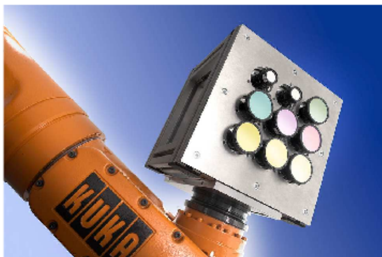
Figura 2.1: Sistema de câmeras combinado com um robô industrial. Conjunto de câmeras utilizado no processo de aquisição de imagens para reconstrução da estrutura tridimensional da cena.
