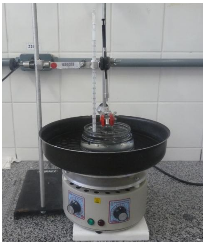
Figura 10: Esquema da Micro-extração em fase sólida – SPME em banho de glicerina para BTEX
