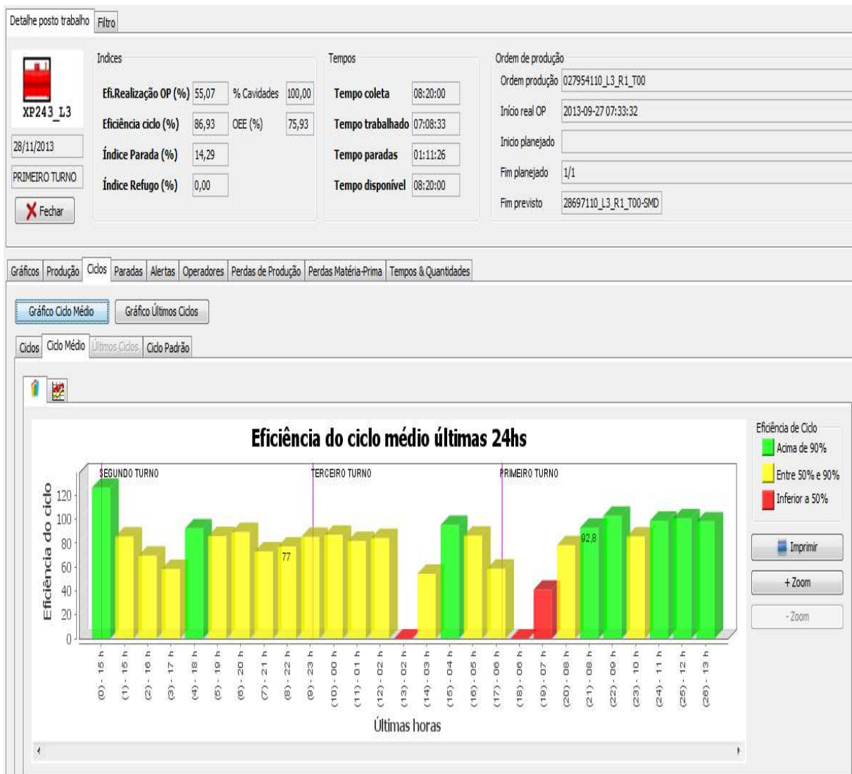
Figura 25 – Eficiência média dos ciclos de montagem nas últimas 24 horas Fonte: Tela do IDW adaptada pelo autor (2014)
