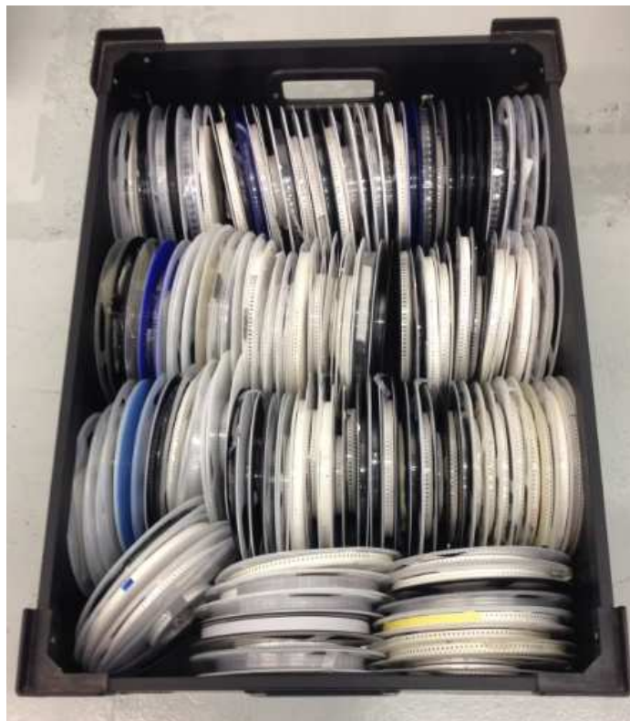
Figura 32 – Caixa de componentes SMT
