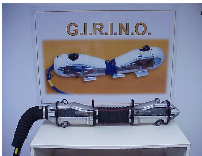
Figura 26 - Robô G.I.R.I.N.O.: Protótipo de Laboratório (branco) e na versão Cabeça de Série Operacional (em metal).
