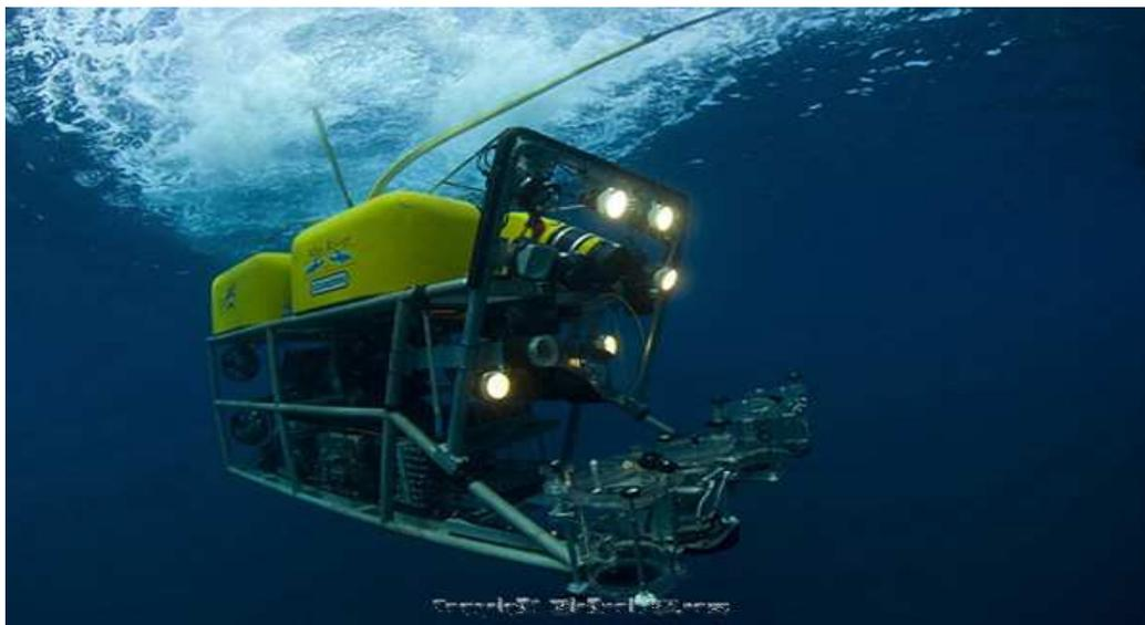
Figura 35 - Veículo de Operação Remota (R.O.V), normalmente usado em operações submarinas na indústria do petróleo e em pesquisas científicas.
