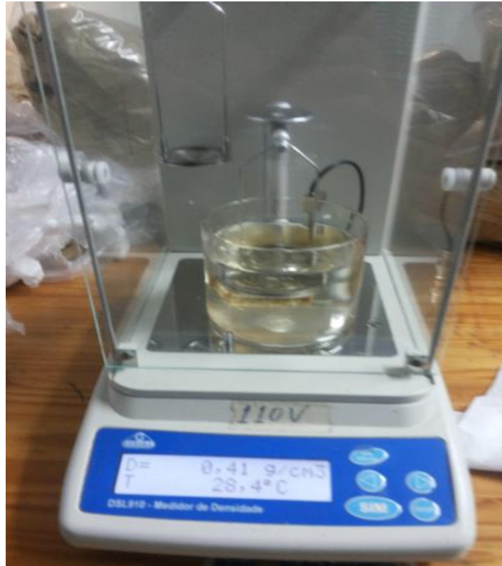
Figura 9 – Medidor de Densidade DSL 190, em que foram medidas as densidades básicas de nove espécies da vegetação do sub-bosque de um plantio de Castanha do Brasil no Município de Itacoatiara-AM
