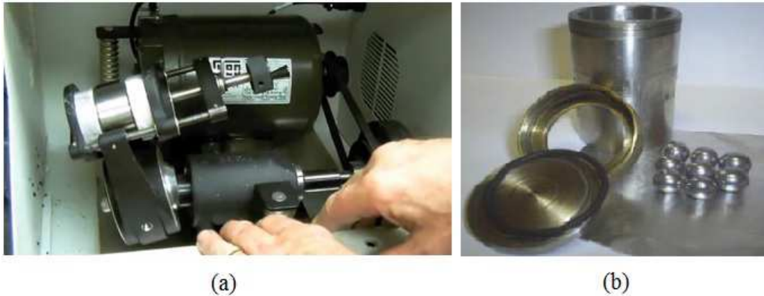
Figura 2.3: (a) Moinho SPEX (modelo 8000), (b) cilindro e as esferas de aço inoxidável.
