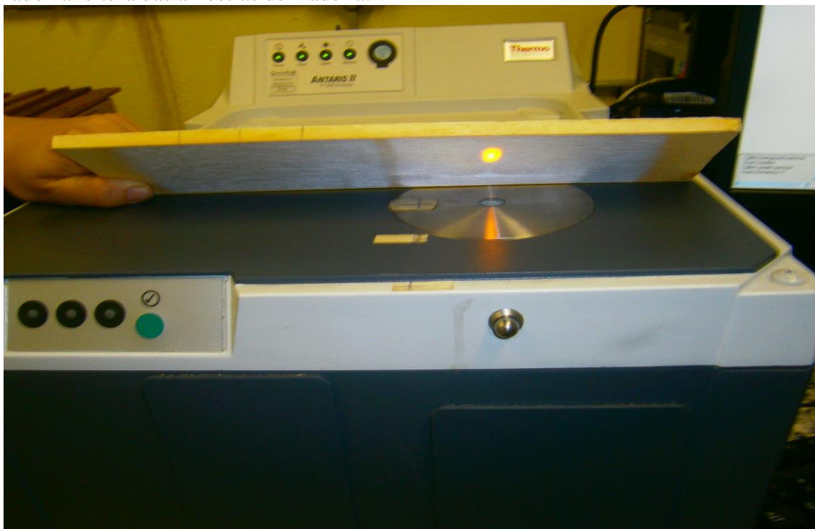
Figura 22. Espectrofotômetro FT-NIR Analyser, modelo Antaris II - Thermo Scientific utilizado na leitura das amostras de madeira.
