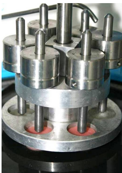
Figura 5 : Corpos de prova sendo polidos na Politriz Metalografica com lixa de granulação 320, 400 e 600 em 600RMP com irrigação constante.
