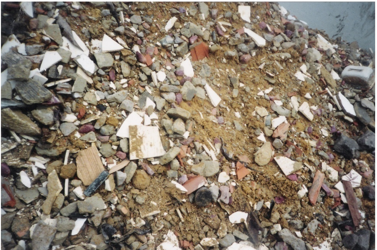
Figura 15 – Material separado para fins não estruturais. Fonte: Cedida GEOTEC/UFAM, 2001.
