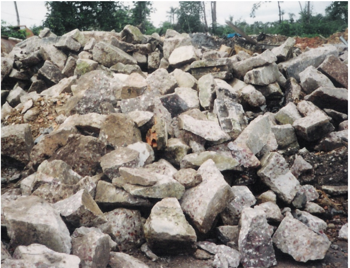
Figura 13 – Resíduo estrutural selecionado para britagem. Fonte: Cedida GEOTEC/UFAM, 2001.
