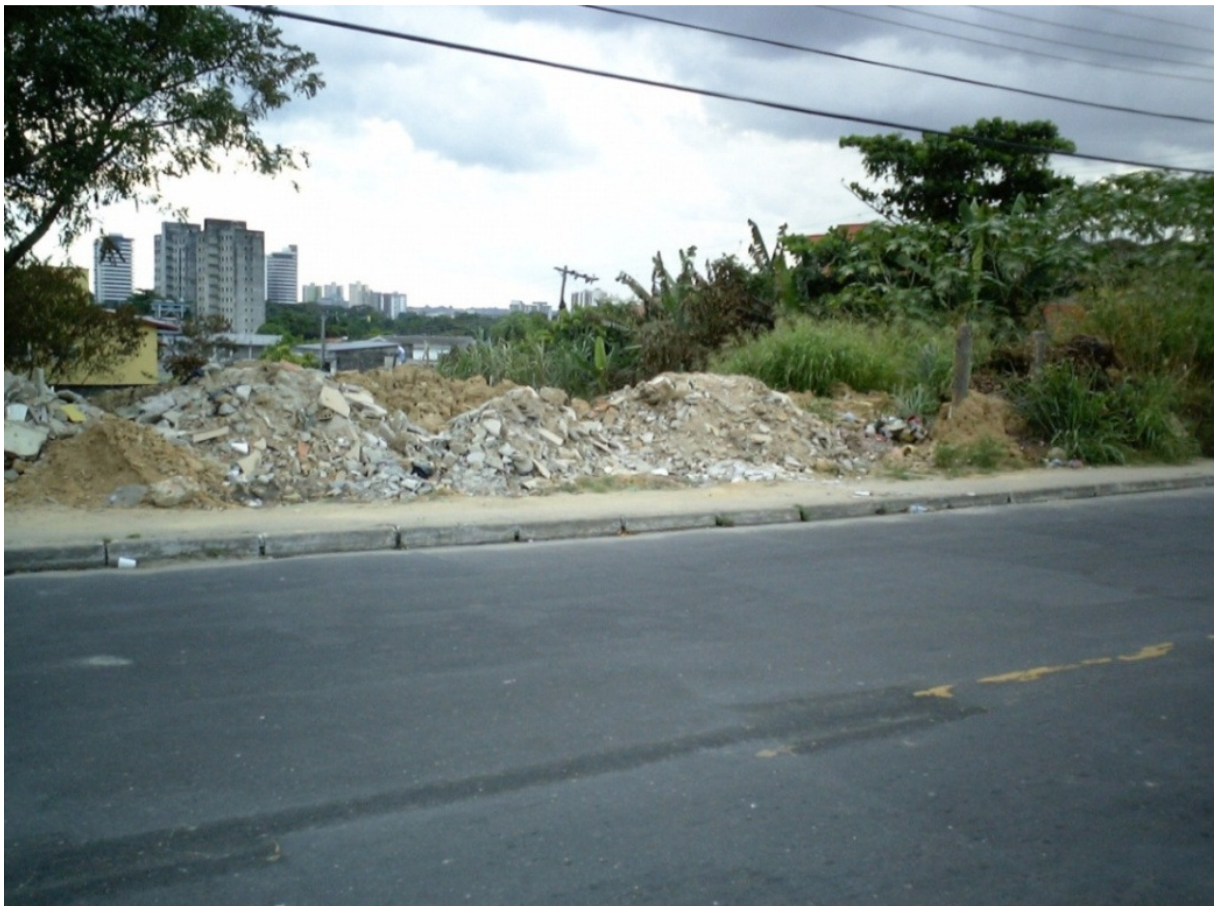
Figura 8 – Disposição clandestina de RCD na Rua Belo Horizonte, Bairro do Aleixo, em Manaus. Fonte: Cedida pelo Eng. Marcelos Marcião, SEMOSBH/PMM, 2006.
