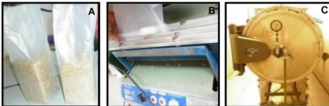
**Figura 3.** Acondicionamento dos substratos: A- Adição em sacos do tipo PEAD (polietileno de alta densidade); B – Fechamento dos sacos em seladora a quente; C – Autoclavagem.
