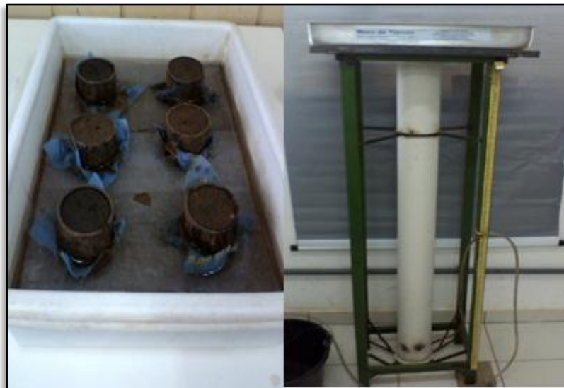
Figura 5. Saturação das amostras por elevação gradual de um lamina d'água e mesa de tensão.
