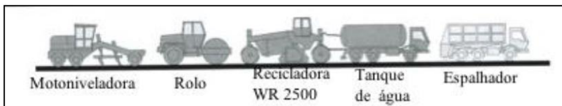
Figura 5 – Trem de reciclagem com adição de cimento Portland.
