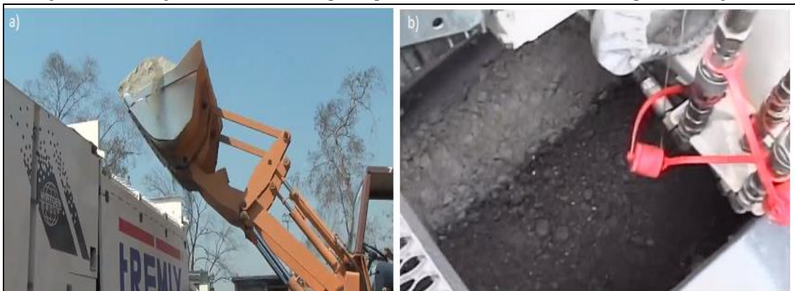
Figura 20 – a) Segundo silo recebendo pó de pedra; b) Materiais sobre a correia para a dosagem.
