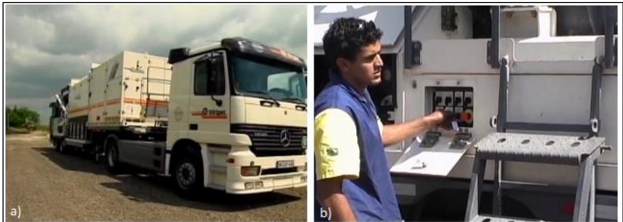
Figura 18 – a) Usina KMA 200 sobre cavalo mecânico; b) Operador calibrando a usina.
