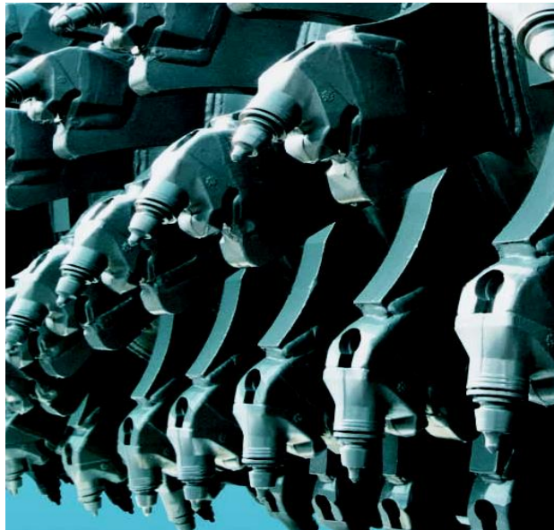
Figura 25 - Disposição em “V” das ferramentas de corte da recicladora Wirtgen 2500 S.
