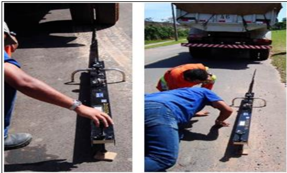
Figura 38 – Ensaio para determinação das deflexões com a viga de Benkelman.
