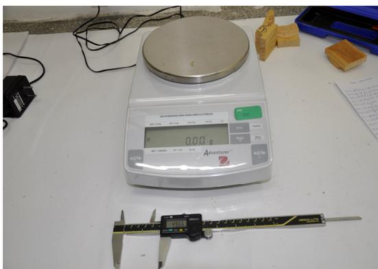
FIGURA 17 - Balança Ohaus Adventurer 3,1 kg e Paquímetro digital Mitutoyo 0-200 (mm), resolução 0,01(mm).
