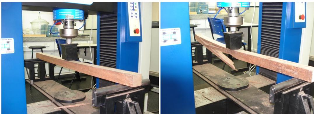
FIGURA 20- Ensaio de flexão com a espécie Breu-vermelho
