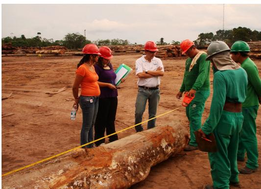
FIGURA 4 - Medição de comprimento de toras
