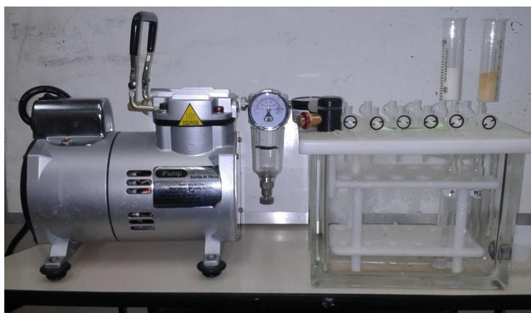
Figura 3.27: Equipamento para extração em fase sólida (SPE)
