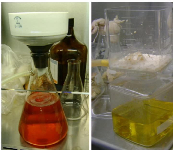
Figura 3.12: Filtração do meio fermentado com funil de Büchner (esquerda) e membrana microporosa (direita).
