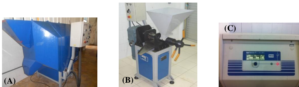
Figura 22 - Cozinhador (A) e prensa (B) SCOTT TECH modelo ERT 60II e centrífuga SIGMA 6-15 (C).
