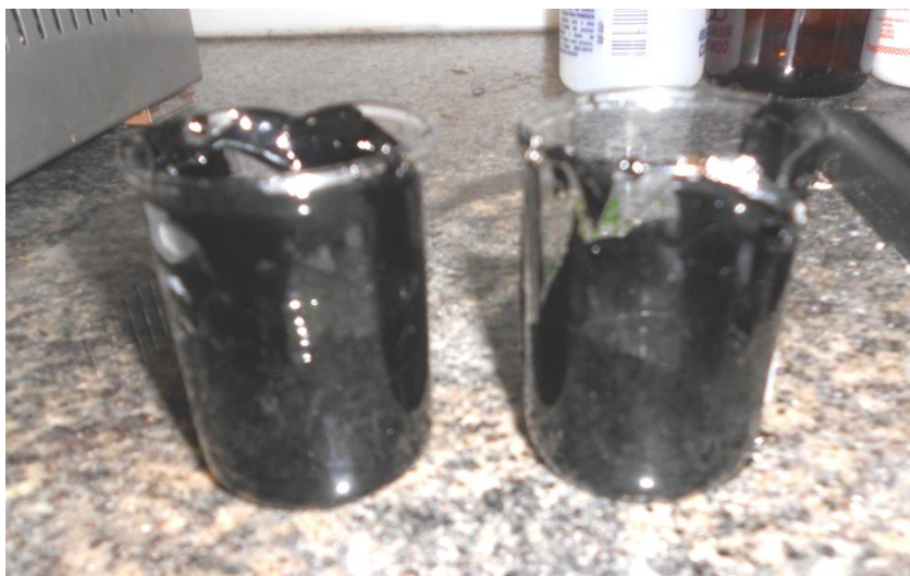
Figura 35 - Bio-óleo obtido por craqueamento térmico do óleo do pinhão manso a 400°C. FONTE: Cristiane Daliassi
