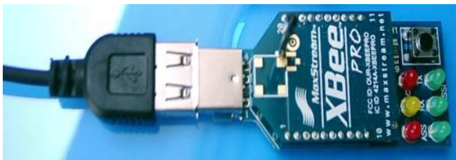
Figura 15 - Placa CON-USBBEE com módulo Xbee Pro.
