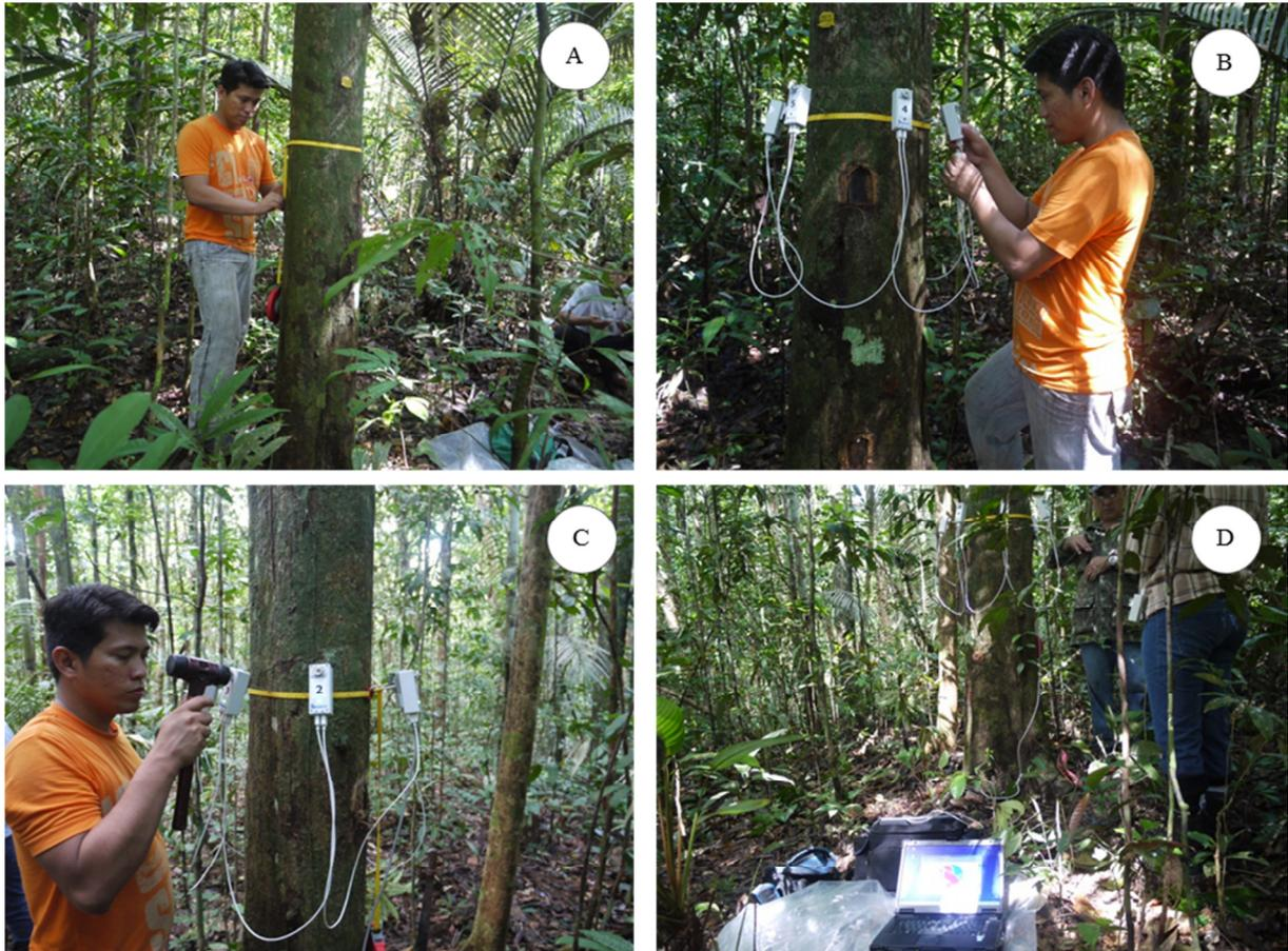
Em cada sensor foi produzida uma onda de impacto através de pancadas de martelete, realizando no mínimo 05 batidas por sensor, ou até alcançar valor abaixo de 10% de erro da matriz Delta do software como recomendado pelo manual do equipamento (RINNTECH, 2005).
