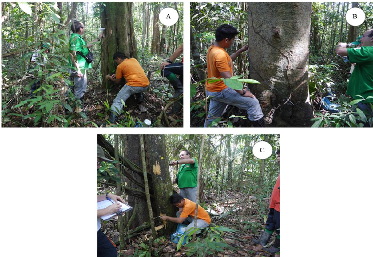
Conforme recomendação de Puehringer (2002) tanto o impacto, quanto a recepção das ondas foi realizada diretamente na madeira, sem a casca, para evitar interferência da mesma sobre as ondas de tensão.
