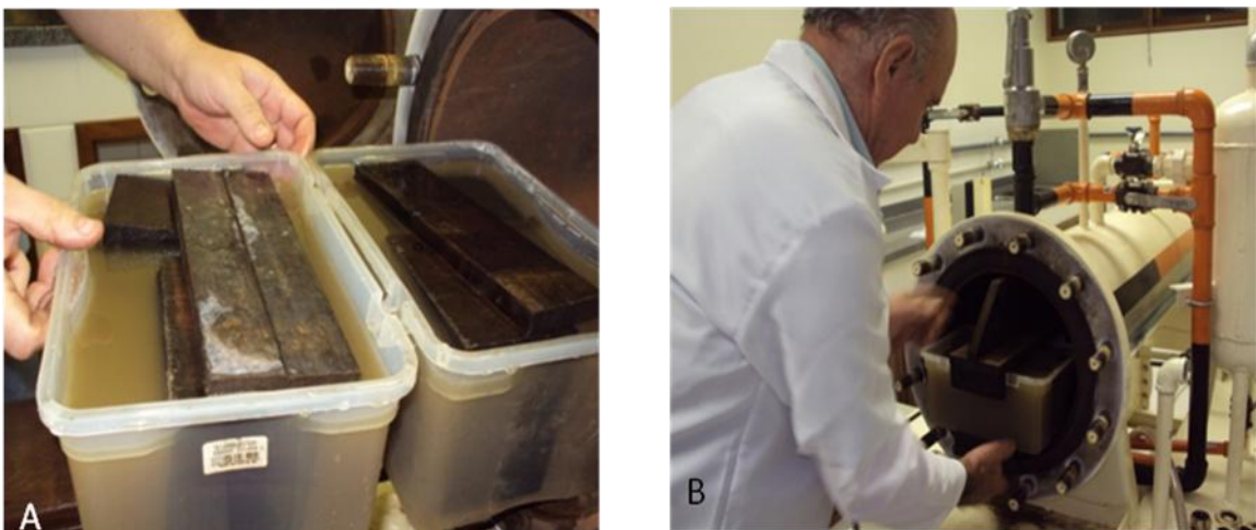
Figura 10: A - Blocos nas cubas com água B - Cubas no Autoclave Fonte: acervo Dias, Aidson (2012)
