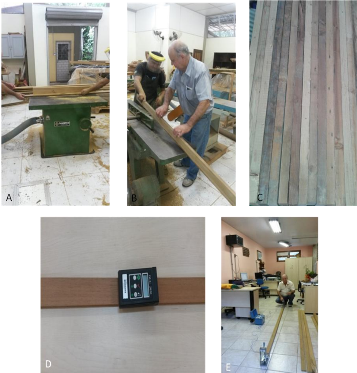
Figura 17: A - Secionando laminas B - Aplainando as laminas C- Lâminas visualmente sem defeitos D - Medidor de teor de umidade E- Medição com equipamento Stress Wave Timer Fonte: acervo Dias, Aidson (2014).
