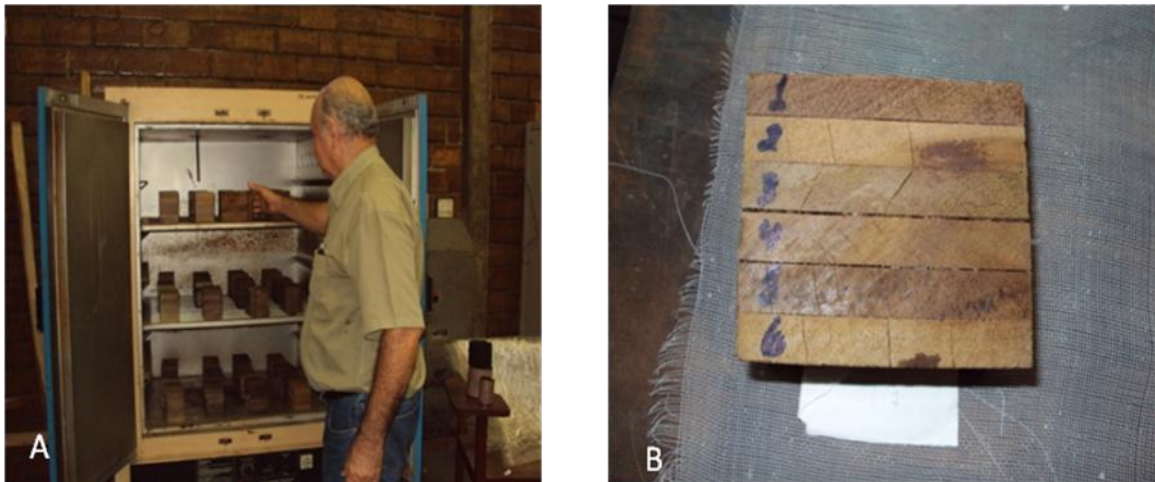
Figura 14: A - Secagem B - Delaminação Fonte: Dias Aidson (2012).
