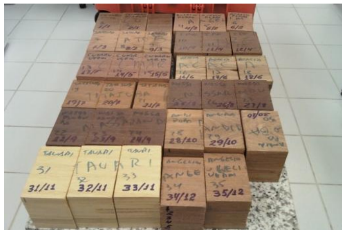
Figura 8: Blocos para teste de delaminação Fonte: Dias Aidson (2012)
