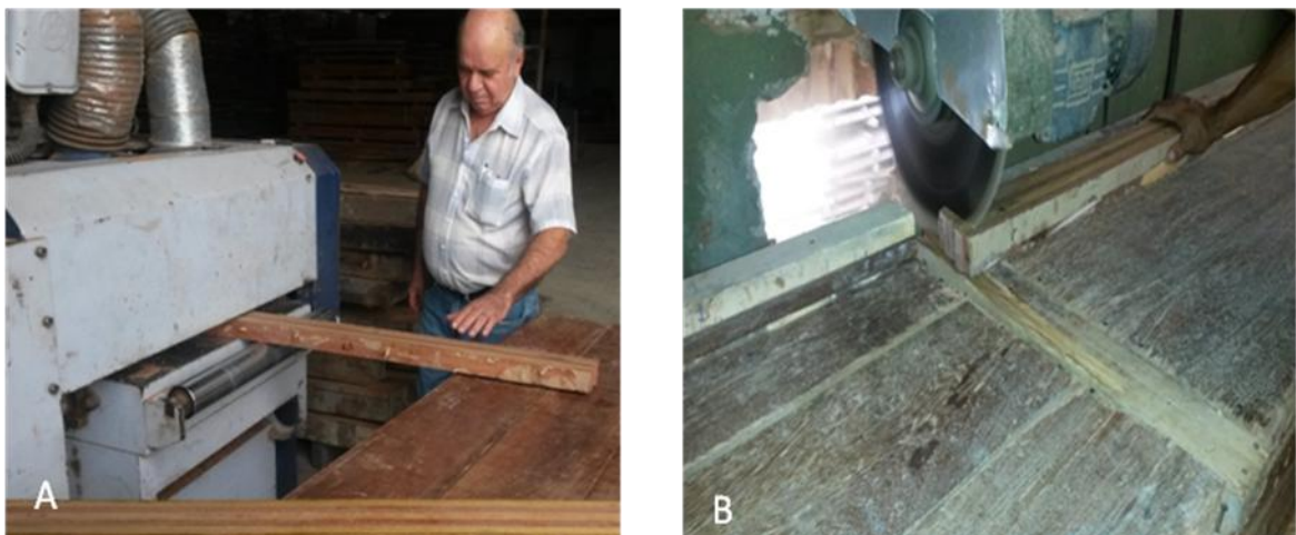
Figura 23: A- Viga na plaina de dupla face B- dimensionamento da viga Fonte: Dias, Aidson (2014)
