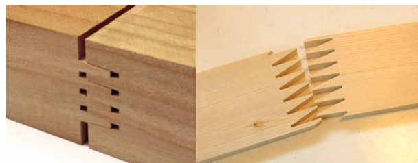
Figura 2: Tipos de usinagem das emendas dentadas Fonte: http://www.salvaro.com.br/produto/linha_primer
