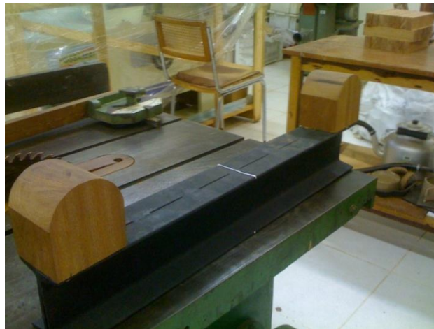
Figura 26: Viga de aço para distribuição da carga Fonte: acervo Dias, Aidson (2014)
