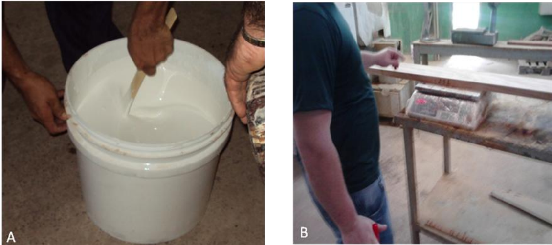
Figura 4: A - Mistura da cola, B - Pesagem da lâmina sem cola Fonte: Dias, Aidson (2012)
