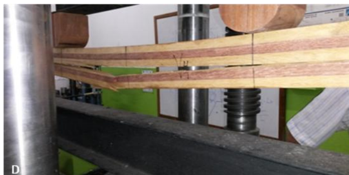
Figura 33: A; B; C e D - Rompimento das vigas
