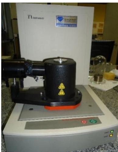
Figura 16: Calorímetro célula DSC 2010 do Laboratório de Síntese e Caracterização de Materiais –LSCM do Departamento de Física da UFSC.
