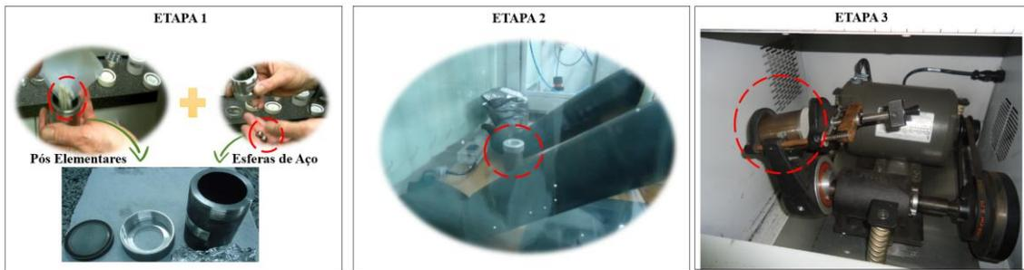
Figura 5: Esquema simplificado das etapas envolvidas na técnica MA. Etapa 1) Adicionamento de pós e esferas dentro do vaso de moagem; 2) Fechamento do conjunto pós + esferas em atmosfera inerte e 3) Montagem do cilindro no moinho.
