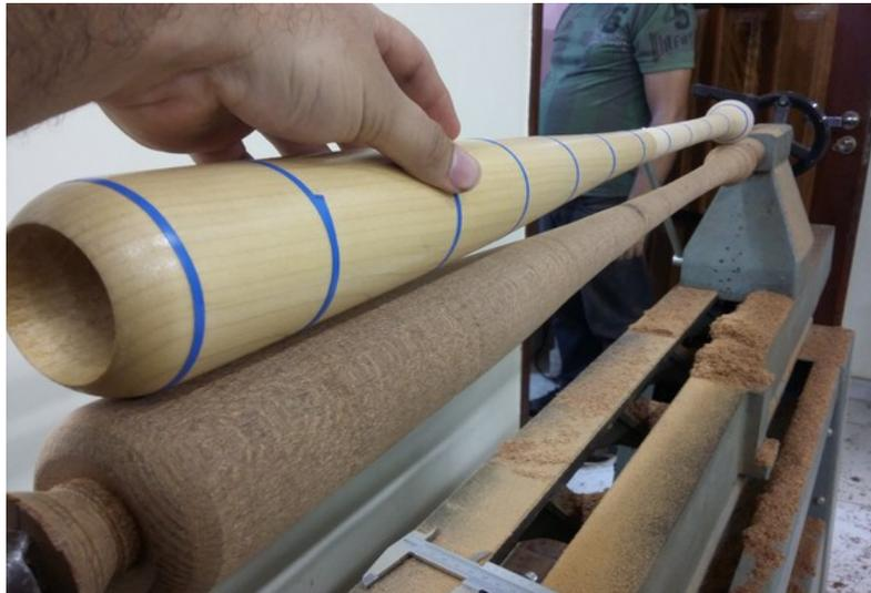
*Figura 25: Modelo original usado para conferência e sobra de 25mm na extremidade do taco torneado.*
