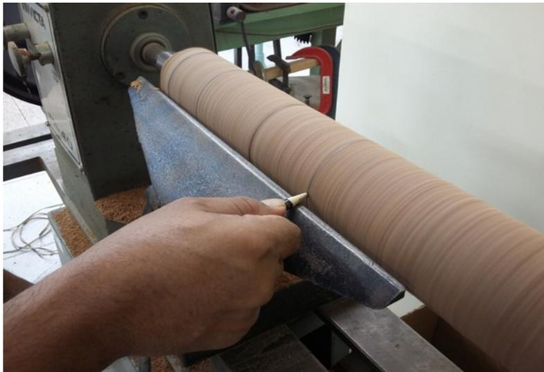
*Figura 22: Demarcação do contorno da seção transversal.*
