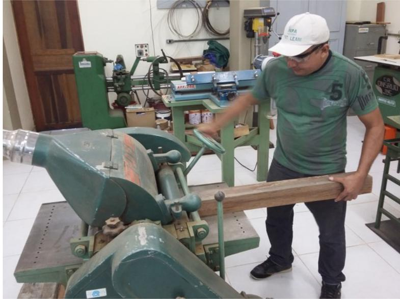
*Figura 16: Peça no processo de desengrosso.*
