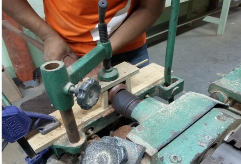
*Figura 26: Rotação manual para cavar a cabeça do taco.*
