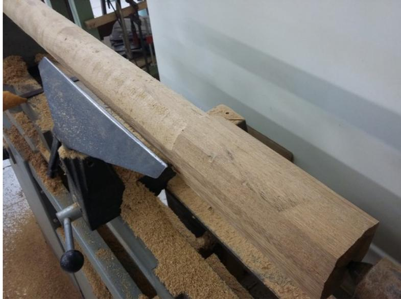
Figura 18: 2/3 da madeira em formato cilíndrico e 1/3 octogonal.
