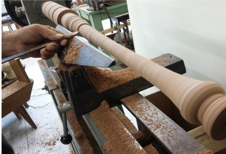
*Figura 24: Torneamento da maçaneta para o barril.*
