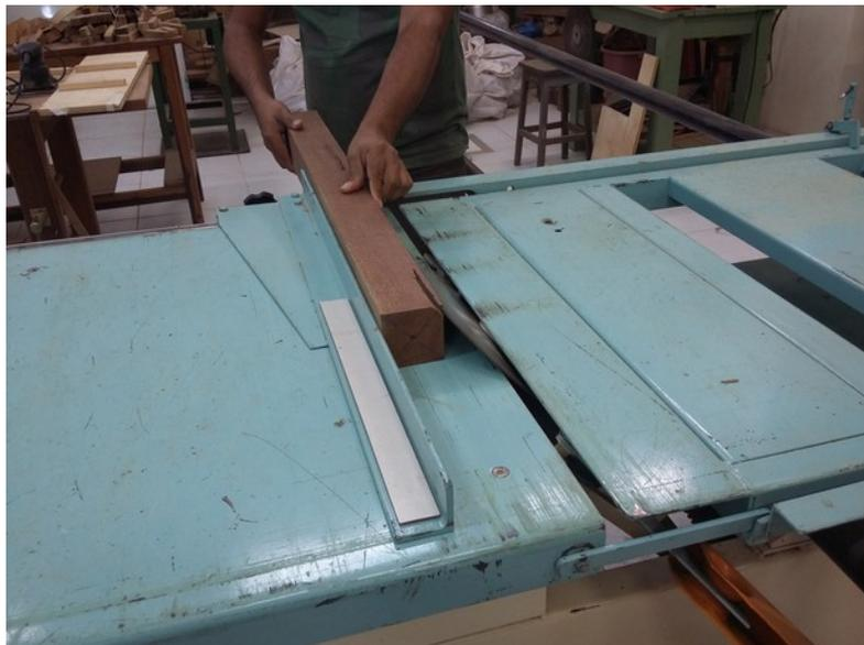
*Figura 17: Serra circular com inclinação de 45°.*
