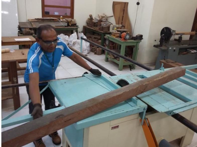
*Figura 14: Conformação da peça em 900mm de comprimento.*
