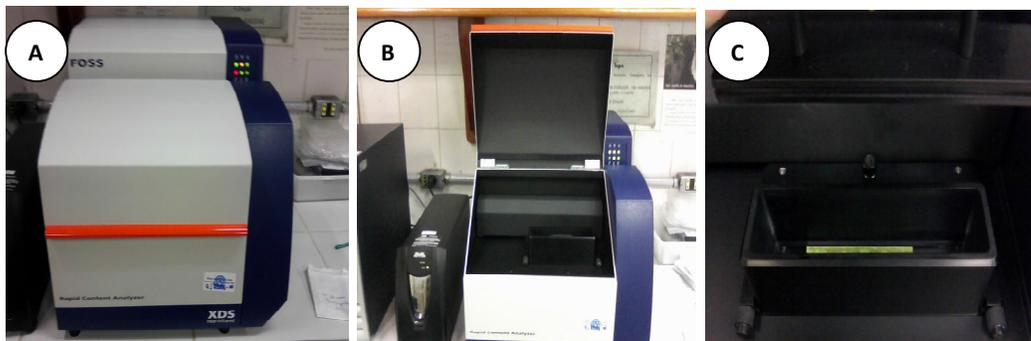
**Figura 1** – Equipamento utilizado para as coletas espectrais. A- Detalhe do equipamento; B- Equipamento com porta aberta; C- Célula de armazenamento de amostras para leitura espectral
