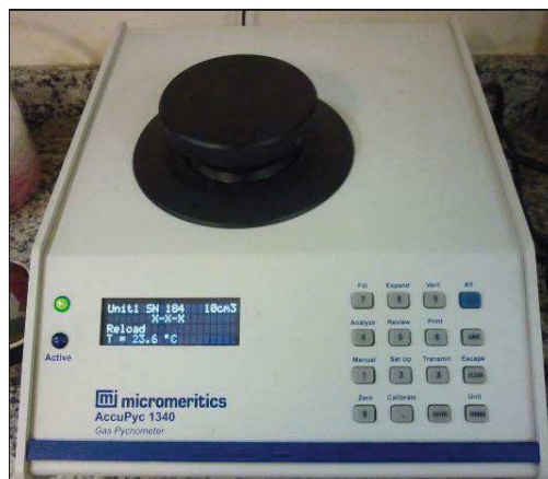
Figuras 3.8 – Picnômetro a gás hélio – AccuPyc 1340 - Micromeritics
