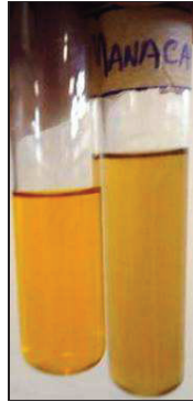
Figura 4.1 - Ensaio colorimétrico do agregado miúdo, à direita
