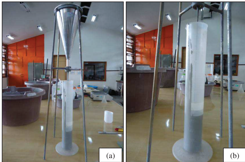
Figura 3.13 – (a) e (b) Ensaio do funil de Marsh
