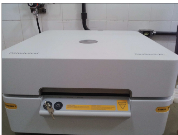
Figuras 3.7 – Espectrômetro de fluorescência de raio X, PANalytical, modelo Epsilon3-XL
