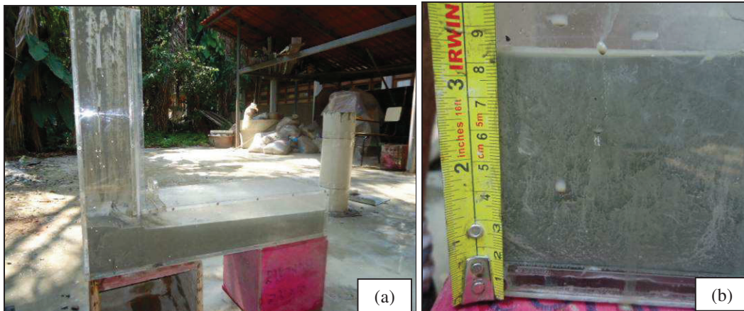
Figuras 4.23 - (a) e (b) Ensaio da caixa L realizado em concreto com adição de RVM na dosagem ótima do superplastificante MC-PowerFlow 1102 (relação sp/c em 1,20%)
