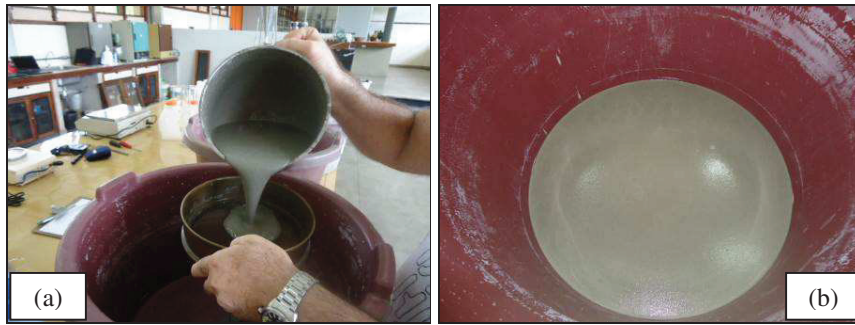
Figura 3.12 – (a) Peneiramento das pastas e (b) descanso por 60 minutos
