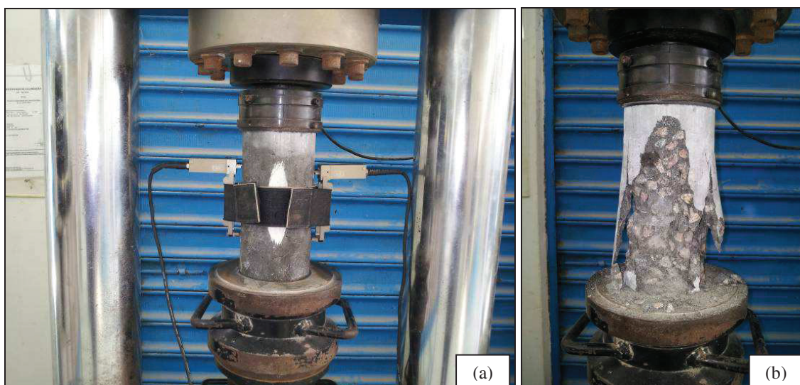
Figuras 4.25 – (a) Ensaio do módulo estático de elasticidade à compressão e (b) de resistência à compressão axial
