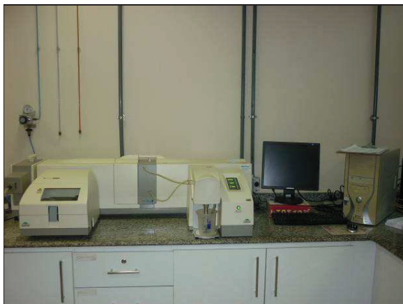
Figuras 3.6 – Granulômetro por difração laser - Malvern MasterSizer 2000
