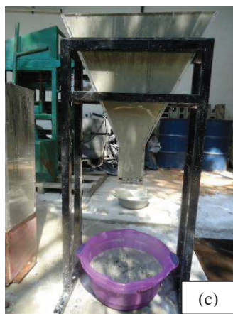
Figura 3.16 – (c) Ensaio do funil V
