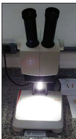
Figuras 3.9 – Estereoscópio LEICA EZ4
