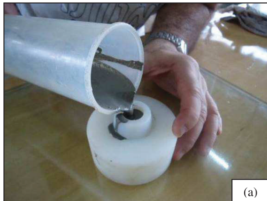
Figura 3.14 – (a) Preenchimento do minicone de Kanro com a pasta a ensaiar
