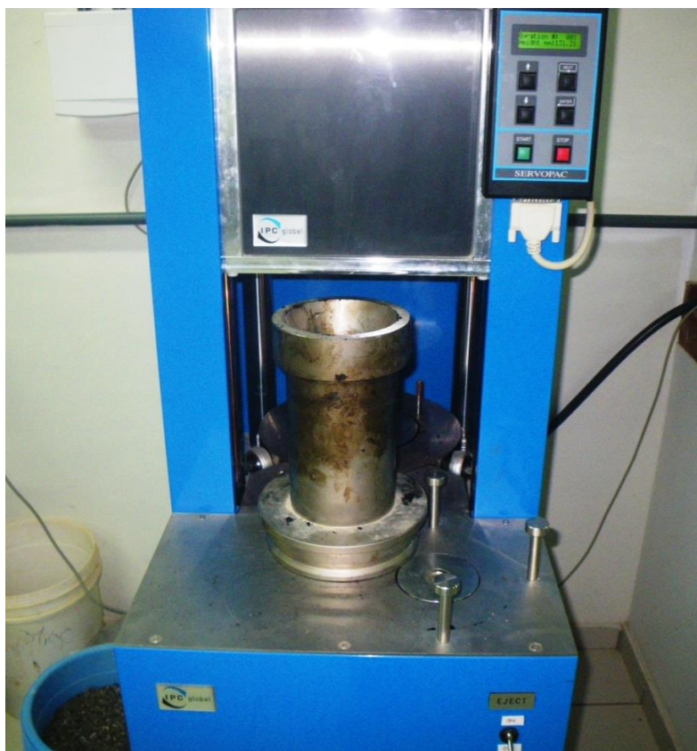
Figura 3.5 – Compactador Giratório Superpave do Geotec.
