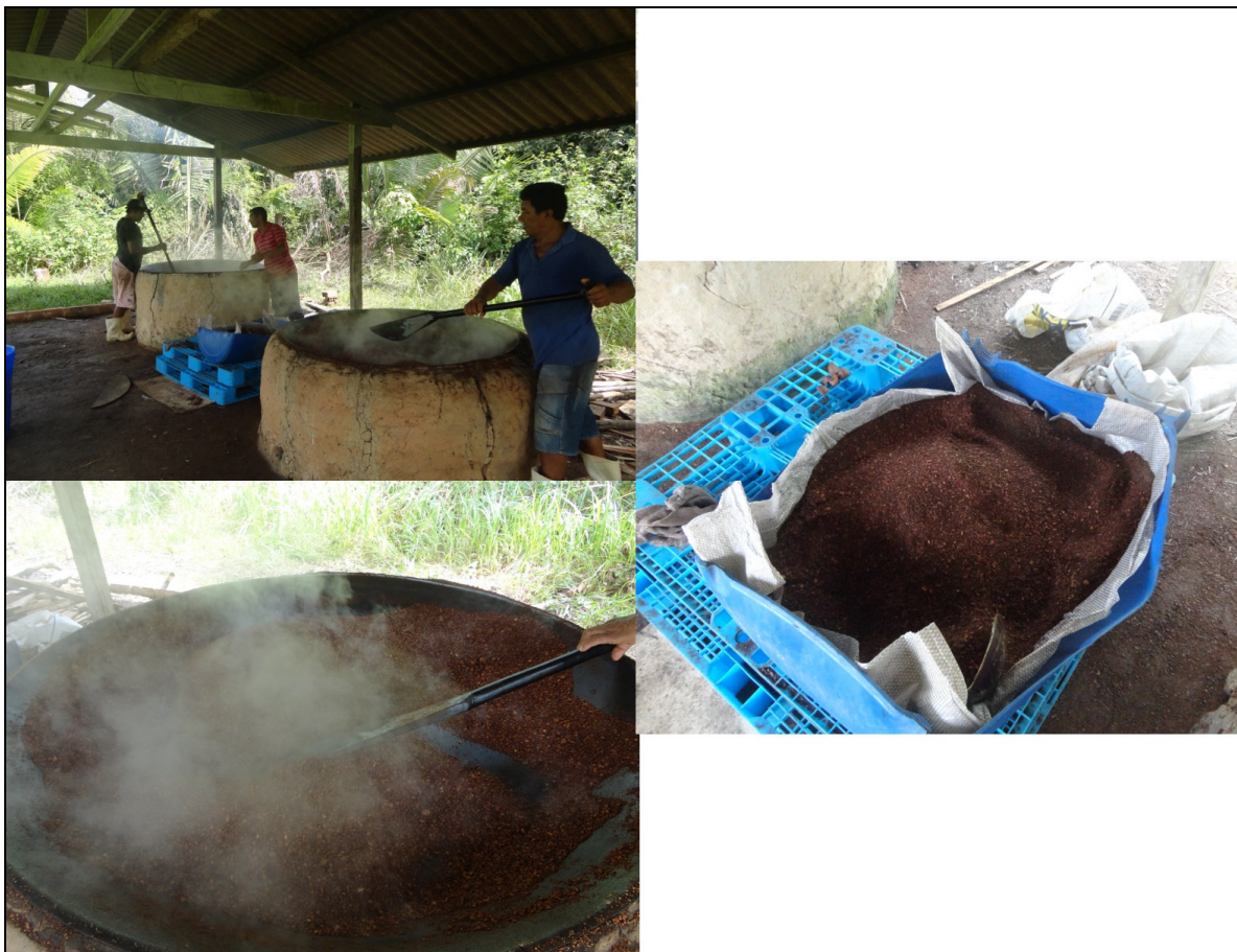
Figura 09 – Andiroba sendo torrada para em seguida ser colocada nas máquinas. Somente após esse processo, que é possível utilizar as máquinas para a extração do óleo vegetal. Fonte: trabalho de campo, maio de 2013.
