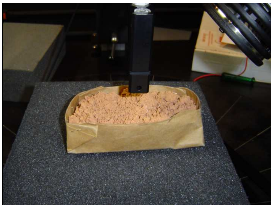
Figura 17 – Acondicionamentos das amostras e obtenção dos dados radiométricos
