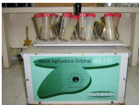
*Figura 6 - Amostras em agitação orbital.*
