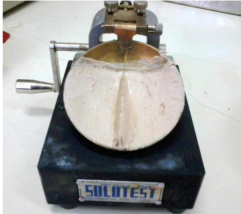
Figura 16 – Aparelho Casagrande com amostra preparada para a execução do ensaio. Foto do Autor.
