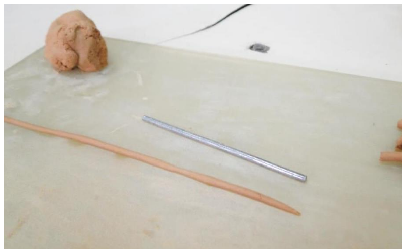
Figura 17 – Gabarito de 3 mm de espessura e 10cm de comprimento com amostra. Foto do Autor.
