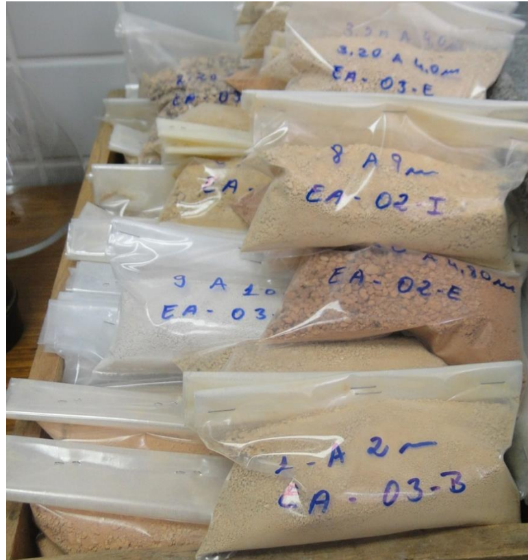
Figura 06 – Amostras coletadas, armazenadas e identificadas corretamente. Foto do autor
