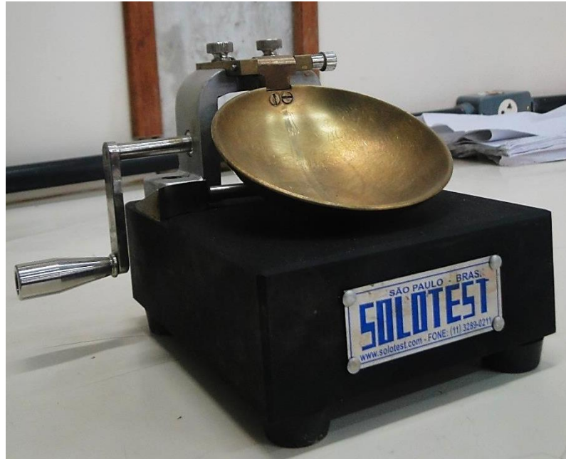
Figura 14 – Aparelho Casagrande, usado nas análises de limite de liquidez, concha é a parte dourada. Foto do Autor.
