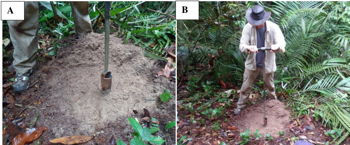
Figura 14 – A) Fotografia mostrando a preparação da área para perfuração do buraco para colocação do piezômetro; B) Perfuração com trado.
