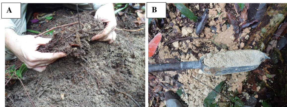
Figura 18 – Fotografia mostrando a A) Camada de raízes e substâncias orgânicas; e o B) Trado com amostra a ser coletada.
