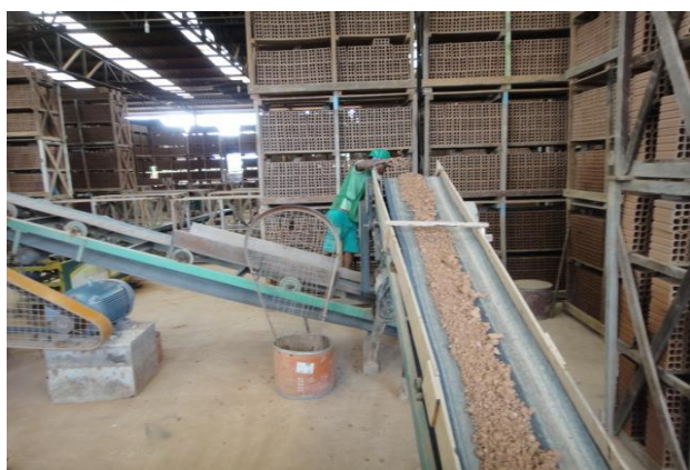
Figura 30 – Argila na esteira saindo do desintegrador e indo para o misturador FONTE: Pinheiro, 2013.
