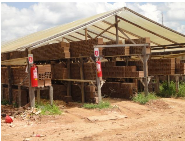
Figura 34 – Casinha usada para secagem natural dos produtos cerâmicos FONTE: Pinheiro, 2013.
