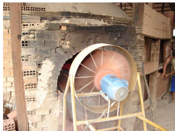
Figura 58 – Ventilador industrial resfriando forno abóboda FONTE: Pinheiro, 2013.
