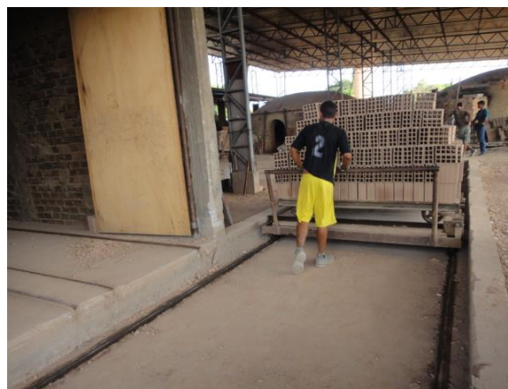
Figura 44– Trabalhador puxando a vagoneta na entrada do secador FONTE: Pinheiro, 2013.
