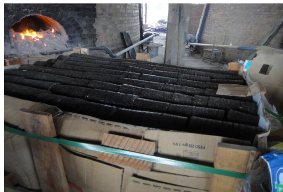
Figura 54 – Briquetes usado como material de queima nos fornos
