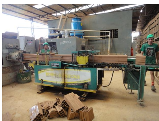
Figura 31 – Argila moldada em formato de tijolo de 8 furos após passar pela extrusora a vácuo FONTE: Pinheiro, 2013.
