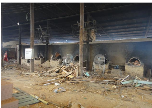
Figura 57 – Ventiladores resfriando o forno paulistinha FONTE: Pinheiro, 2013.
