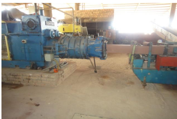
Figura 28 – Extrusora a vácuo, também conhecida como maromba FONTE: Pinheiro, 2013.
