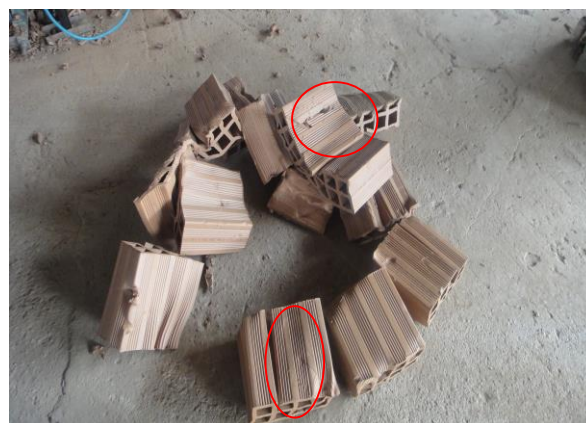
Figura 24 – Tijolos crus com trincas e deformações retirados da linha de produção
