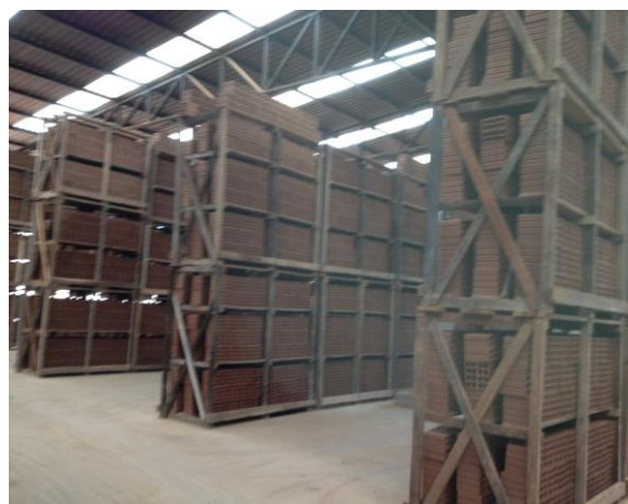
Figura 35 – Produtos cerâmicos em processo de secagem no pátio da fábrica FONTE: Pinheiro, 2013.
