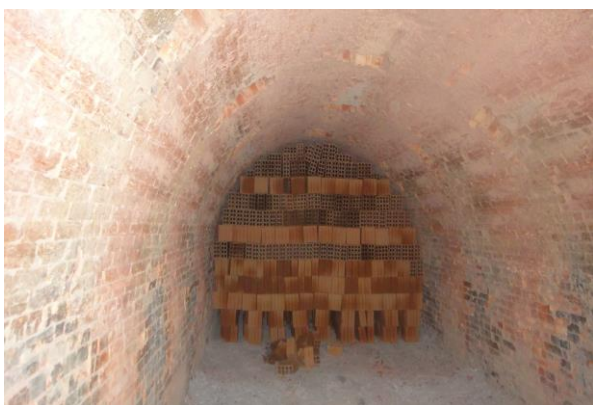
Figura 45 – Tijolos empilhados dentro do forno semicontínuo
