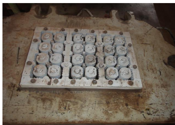
Figura 29 – Boquilha usada para produção de tijolo de 8 furos FONTE: Pinheiro, 2013.
