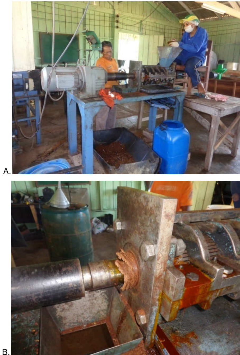
Figura 24: Extração do óleo de buriti. (A) Prensagem para extração do óleo de buriti; (B) Coleta do óleo do buriti
