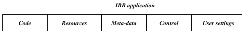
Figura 7 - Sintaxe de formação indicada pelas recomendações ITU-T J.205 e ITU-T J.206. Fonte: Adaptado de [26] [27].
