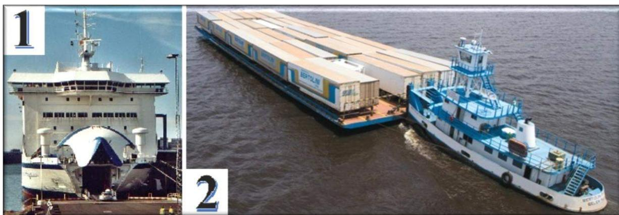
Figura 66 – Sistema de Transporte: 1) Roll on – Roll of. 2) Ro-ro caboclo.
