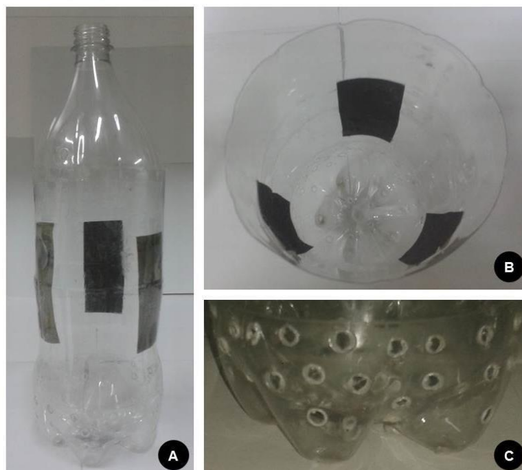
Figura 3. Gaiola utilizada no experimento para isolamento dos casais de Pomacea amazonica . A– Gaiola confeccionada com material reciclado de garrafa de plástico (PET); B – Detalhe dos três tipos de lixa que foram fixadas na parte interna das gaiolas para simular substratos com diferentes rugosidades e C – Detalhe da parte inferior da gaiola com os furos para passagem da água aerada e saída dos metabólitos.
