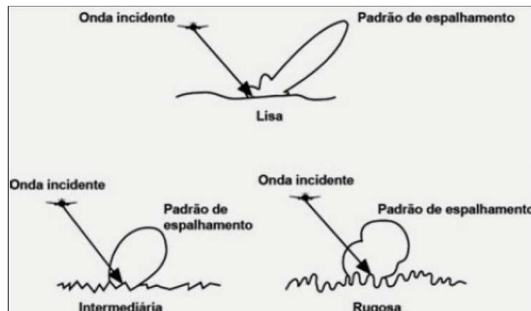
Figura 5. Modelos de padrões de espalhamento em sistema de radar.
