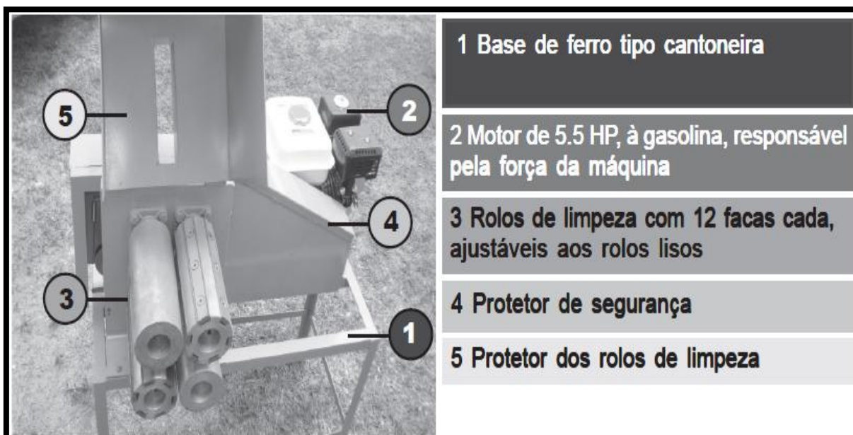
Figura 36: Partes componentes da máquina descorticeira JASA MD12. Fonte: NUSEC/UFAM, 2009.
