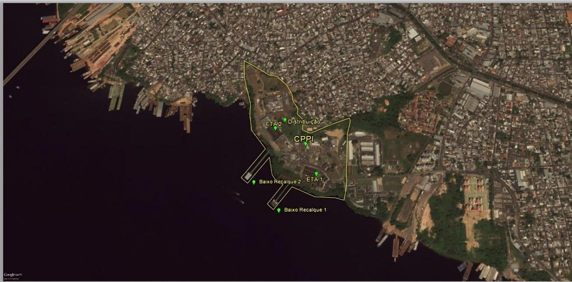
É possível identificar pela Figura 5 a disposição física das principais unidades abrigadas no perímetro do CPPI. Observa-se, na direção sul ao CPPI, as duas unidades de captação de água bruta (Baixo recalque 1 e 2), assim como, as estações de tratamento (ETA 1 e 2) e as unidades de reservação para distribuição.
